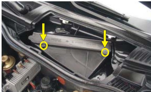
**(PL)** Odkręcić wkręty pokrywy filtra, usunąć pokrywę
